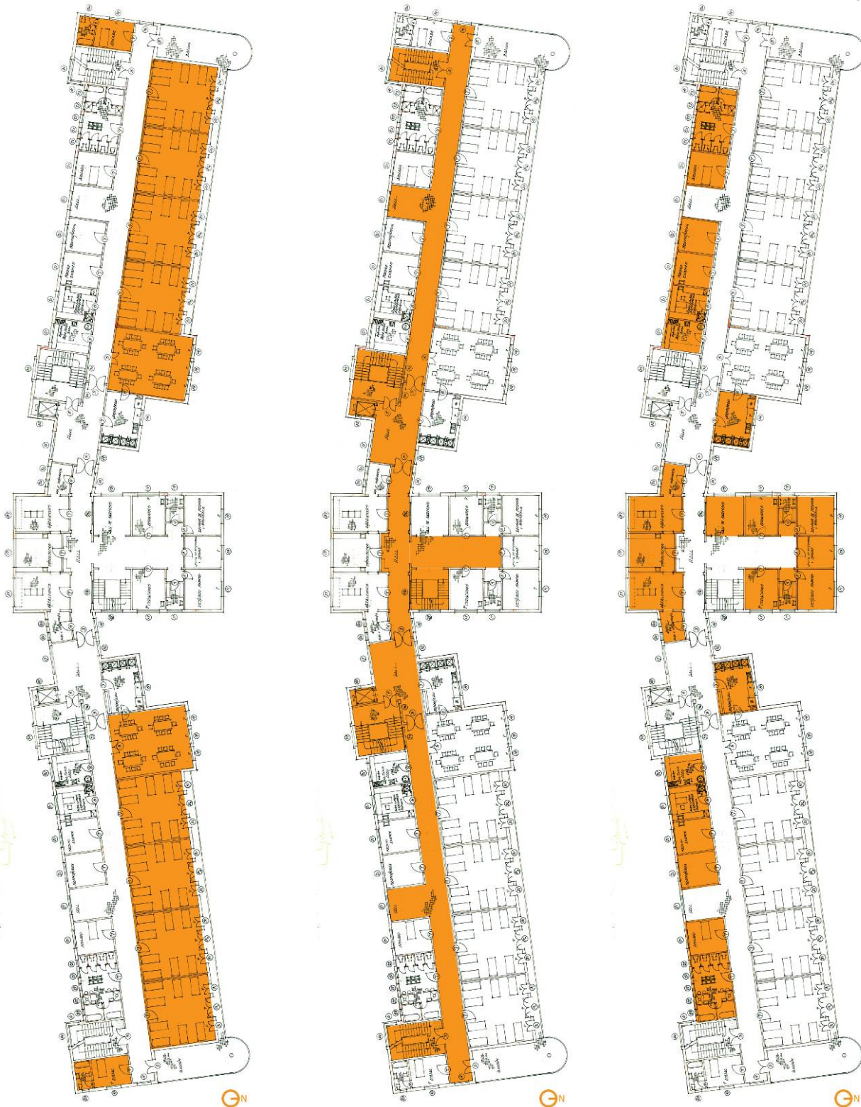
Fig. 8, 9, 10. Planta tipo de hospitalización. Los pacientes se ubican en el ala norte del edificio (salvo los aislados, que están en el lado sur) El pasillo central de circulaciones, junto a los halles, sirve de separador de las áreas de pacientes y servicios. Las zonas de servicios ubican en el ala sur y en el bloque central. Con la salvedad de los reposteros, que están en el lado norte y se conectan directamente a los comedores de los pacientes.
