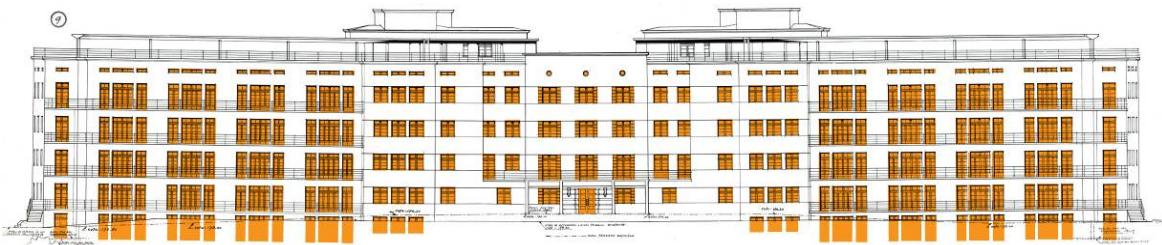
Fig. 25. Alzado norte. Patrón repetitivo de las soluciones de ventanas.
