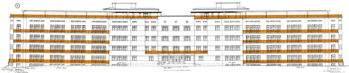
Fig. 24. Alzado norte. Continuidad de las barandas en la fachada principal
