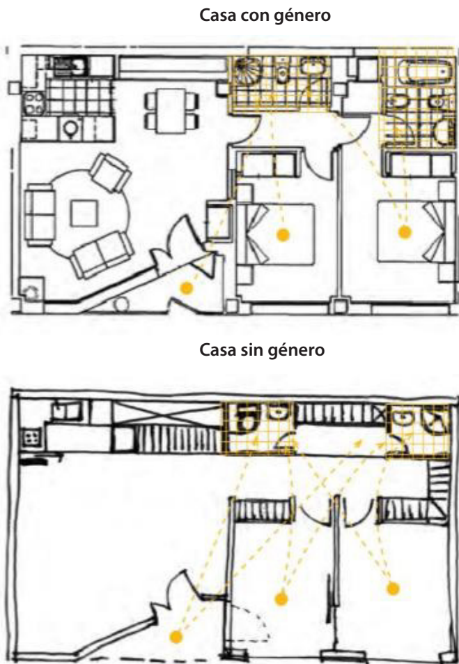
Imagen 2 y 3. Esquema de comparación de casa con y sin género. Fuente: Zaida Muxí, 2009, Recomendaciones para un habitar no jerárquico ni androcéntrico.
